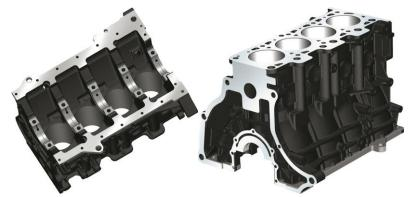
发动机是汽车的心脏,缸体是发动机的关键基础件之一,缸体的制造精度、包括尺寸精度、形位公差、表面光洁度等对发动机的性能至关重要。缸体的铣削加工逐渐采用数控高速加工中心替代传统的专机生产线,这就对刀具的专用性提出了越来越严格的要求。株洲钻石研制出的一系列专业刀具,为缸体加工提供了全套解决方案。
