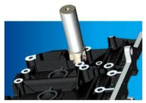
EMP11 多功能凸台铣削刀具,螺钉压紧,转位方便;容屑空间大,排屑顺畅;可进行平面、直角台阶面、槽等多种形式的切削加工。
