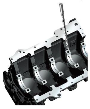
1588SL 深孔麻花<u>钻头</u>,双导向刃带,导向更可靠,加工更稳定,有 12 倍径、20 倍径、30 倍径供选择,良好的满足深孔及有干涉等情况下的钻削加工。
