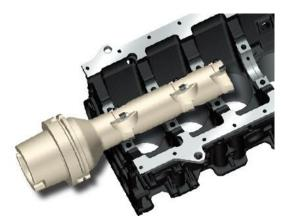
曲轴半圆孔镗削专用刀具,最优化的刀具设计,最大限度的减小振动,确保加工精度和质量, 五个加工位置分两次加工完成。
