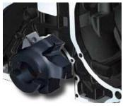
FMP02 系列面铣刀,螺钉压紧,转位方便;容屑空间大,排屑顺畅;可进行平面、直角台阶面、槽等多种形式的切削加工。
