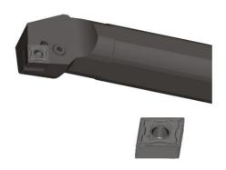
在立车上使用杠杆式内孔车刀加工主轴孔可大大提高加工效率;
