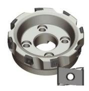
刀片前刀面特殊的曲面设计,有效降低切削力,可采用大进给,加工效率高; 刀片立装,适应大切深重载加工,能快速去除工件毛坯余量,提高粗加工效率; 主偏角为 90 度,可进行方肩铣削。
